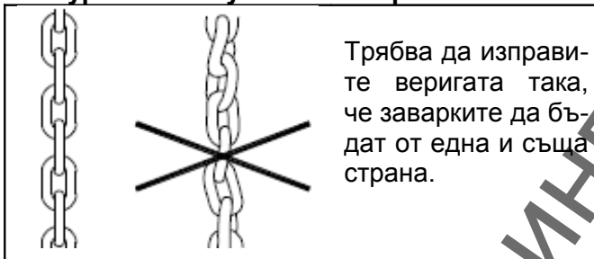
Фигура 6.2.a: Усукване на веригата
